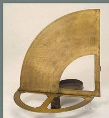
Após séculos de alterações, a ideia original de Pedro Nunes gerou o nónio moderno, que consiste num sistema de duas escalas, uma principal e fixa e uma deslizante, que permitem medir um ângulo ou um comprimento com maior precisão que qualquer das escalas tomadas isoladamente.
