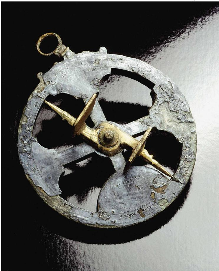
O **quadrante náutico**, utilizado para medir a altura de uma estrela, tem a sua origem num instrumento com que os árabes efectuavam medições astronómicas. Não chegou até nós nenhum exemplar do período da Expansão mas sabe-se que foi utilizado por Diogo Gomes, por volta de 1460.
